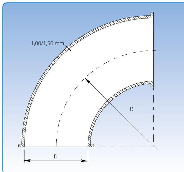
Die genauen Abmessungen können der unten stehenden Tabelle entnommen werden. Durchmesser = (D).  $R = 2 \times D$  für alle Abmessungen.
